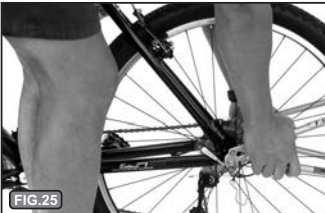
FIG. 25 Position correcte pour attache de la remorque au vélo.
