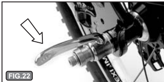
FIG. 22 Levier de Blocage Rapide perpendiculaire à l'avant de la patte.
