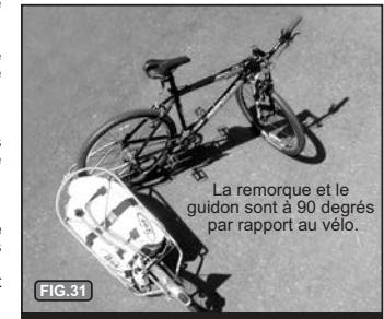
FIG. 31 Position de stationnement. Remarque: le sens correct pour tourner le guidon est en direction de la remorque.
