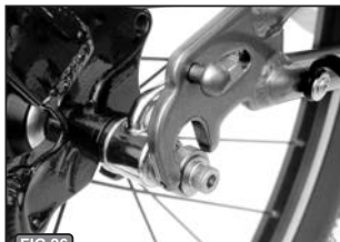
FIG. 26 Ecartement de la bobine ne s'aligne pas avec écartement du crochet. Les bobines doivent être inversées afin qu'elles s'alignent correctement.
