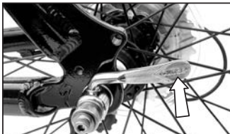
FIG. 23 Levier de Blocage Rapide fermé.
