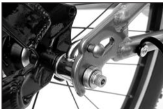
FIG. 27 Crochets de la fourche correctement alignés et installés sur les bobines.
